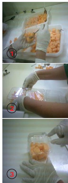
Fig. 6. Sequência do acondicionamento dos melões minimamente processados em embalagens de polietileno tereftalato.
