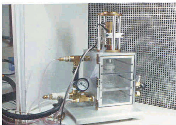
Fig. 2. Equipamento de biobalística utilizado no processo de introdução de genes em células ou tecidos vegetais (ARAGÃO et al. , 1998).
