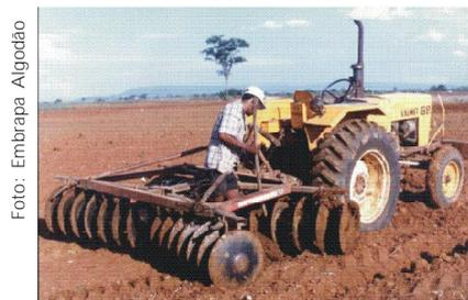
Fig. 2. Grade niveladora.
