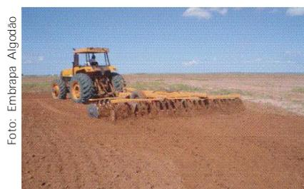
Fig. 4. Grade aradora pulverização do solo.
