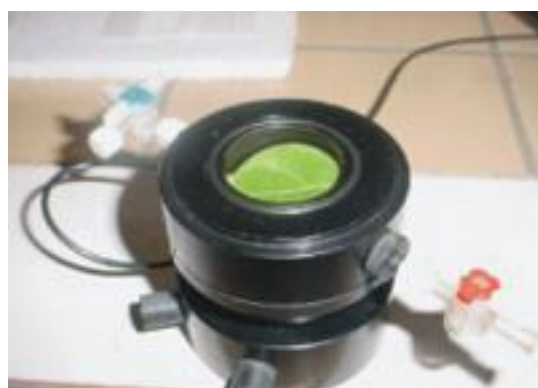
FIG. 1. Detalhe do disco foliar e equipamento para medição da fotossíntese e da respiração oxidativa.
