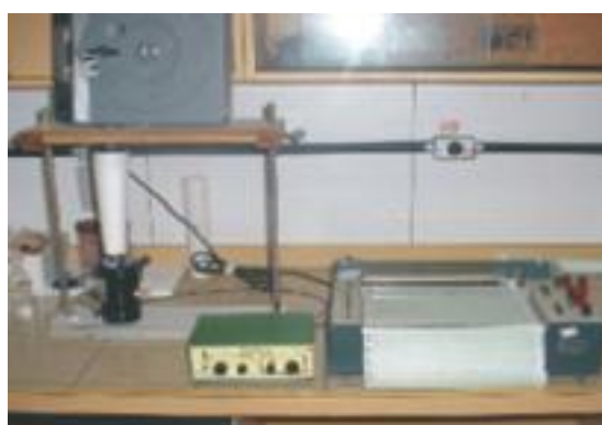
FIG. 2. Vista geral da sonda de oxigênio para medição da fotossíntese e da respiração celular.
