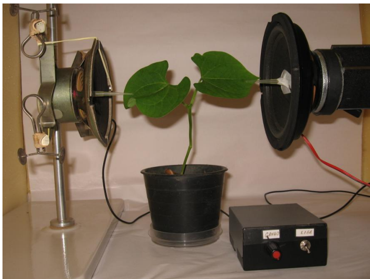
Figura 2. Dispositivo utilizado para bioensaios em plantas com transmissão de sinais vibratórios. A- folha da planta sem vibrações (área controle), B- folha da planta recebendo vibrações (área tratamento), C- cone de plástico, D- alto-falante para reprodução dos sinais, F- amplificador, E- planta de feijão, G- conexão para o computador.
