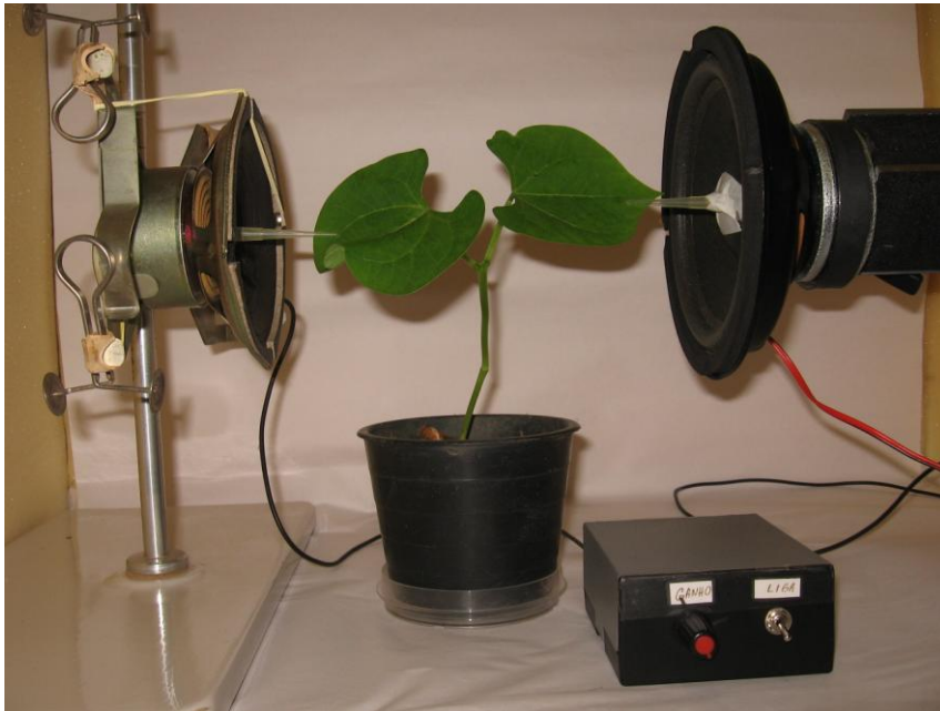
Figura 3: Dispositivo utilizado para bioensaios em plantas com transmissão de sinais vibratórios. A- folha da planta (com um tipo de vibração), B- folha da planta (outro tipo de vibração), C- cone de plástico,
