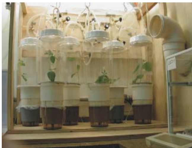
Fig.4. Sistema de aeração de plantas montado com a soja.
