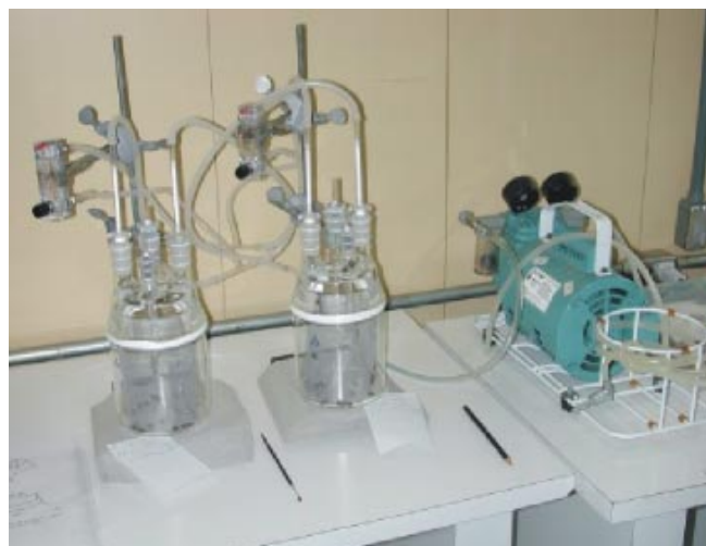
Fig.3. Sistema de aeração para coleta de voláteis montado em câmaras de vidro.
