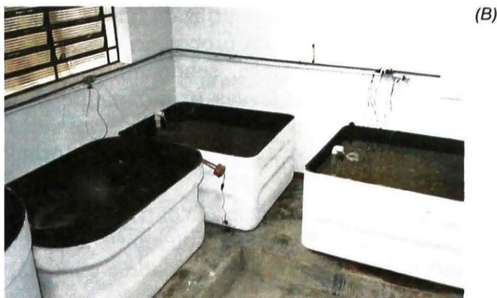
**FIGS. 3A e 3B. Filtro biológico em sistema fechado descontinuo, montado com substrato de seixos rolados: A - layout e B - caixas de fibrocimento.**
