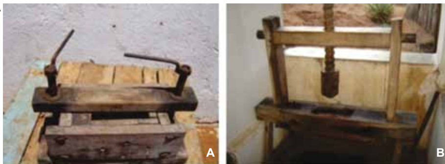
Figura 2. Tipos de prensas de madeira utilizadas na fabricação de queijo coalho na Comunidade de Tiasol: a) prensa de madeira de mesa; b) prensa de madeira de fuso.
