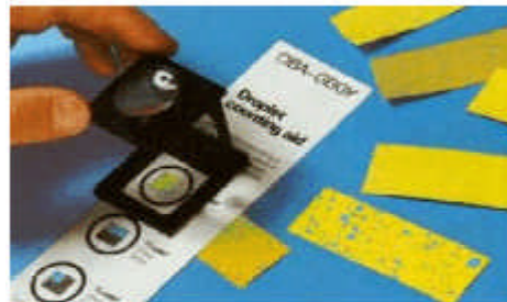
Figura 3. Etiquetas amostradoras usadas na avaliação da cobertura das gotas.
