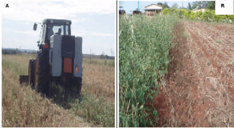
Figura 3. Equipamento capaz de produzir descarga elétrica a partir da rotação da tomada de força do trator e eliminar as espécies daninhas. Barra na dianteira para dessecação pré-semeadura (A). Área não dessecada-testemunha (esquerda) e área dessecada (direita) (B).
