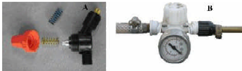
Figura 4. Válvula reguladora de pressão com molas amarela (1 bar / 14,22 lb pol -2 ) e azul (2 bar / 28,44 lb pol -2 ) (A); regulador do tipo registro (B).
