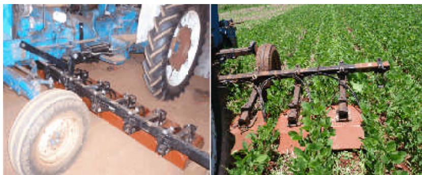
Figura 4. Campânulas de aplicação, dispostas em uma barra, acoplada perpendicularmente à parte central do trator.
