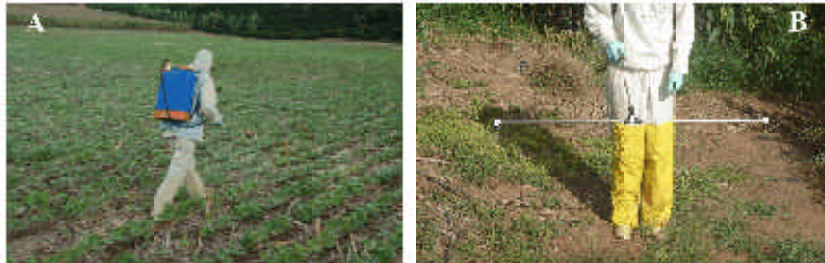
Figura 1. Pulverizador costal manual (A); barra de alumínio para pulverizador costal com duas pontas de pulverização espaçadas de 1,0 m (B).
