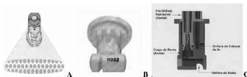
Figura 7. Pontas de jato leque de impacto: turbo Floodjet - TF (A), turbo Teejet - TT (B) e corte da turbo Teejet com indução de ar – TTI (C).
