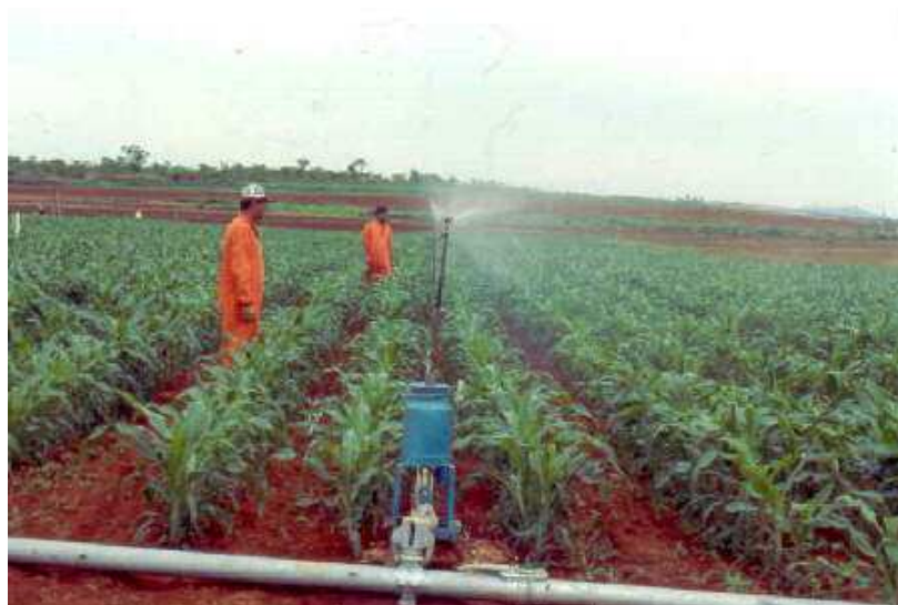
Fig. 29 Equipamento portátil de injeção desenvolvido na Embrapa Milho e Sorgo denominado "vaquinha".
