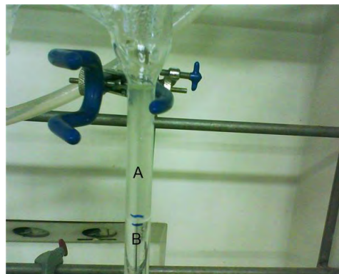
Figura 2. Separação da fase aquosa do óleo essencial. a) óleo essencial de Citrus aurantifolia e b) Fase aquosa.
