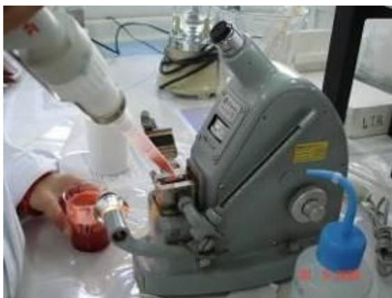
**Figura 4** – Refratômetro utilizado para determinação de sólidos solúveis totais. Embrapa Clima Temperado, FAEM/UFPel, Pelotas, 2011.
