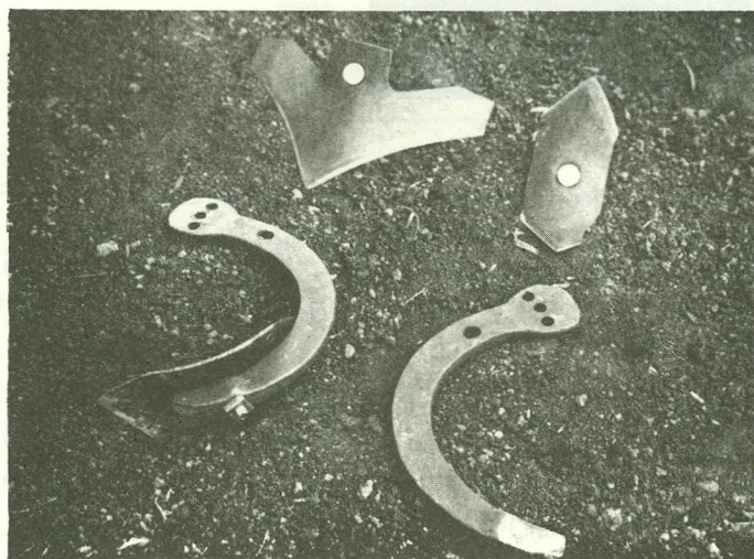
Figura 6. Partes componentes de um cultivador a tração animal: A. enxada tipo "picão"; B. enxada tipo "asa-de-andorinha"; C. braços do cultivador.
