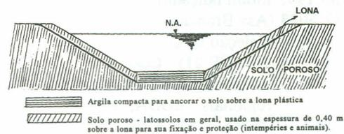
**FIGURA 100.** Tanque em construção (foto), impermeabilizado com lona de plástico, conforme ilustra o desenho.
