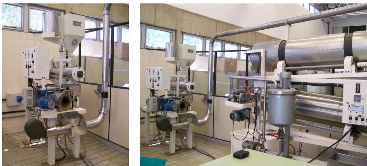
Figura 4. Extrusor Inbra RX50, rosca simples utilizado para a produção dos extrudados expandidos de milho e feijão. À esquerda: módulo extrusor; à direita: sistema completo dotado de fluxo pneumático, cilindro secador e temperador (créditos: Erika M.M. da Silva)
