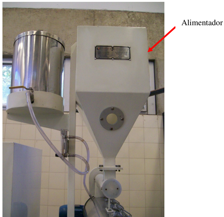
Figura 1. Alimentador acoplado ao sistema de extrusão (créditos: Erika M.M.da Silva)
