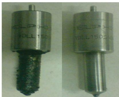
**Figura 44.** Bicos injetores carbonizado e limpo.
