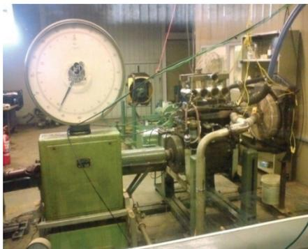
**Figura 1.** Motor em bancada dinâmométrica.
