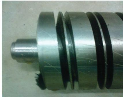
**Figura 14.** Trocador de calor de aço inoxidável parcialmente usinado (detalhe da aleta).
