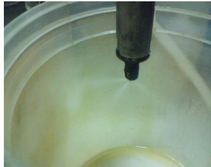
**Figura 28.** Teste do bico injetor do motor experimental com óleo diesel à temperatura ambiente.
