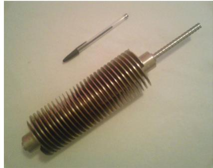
**Figura 22.** Trocador de calor e inserto tratados superficialmente com níquel químico (vista em conjunto).
