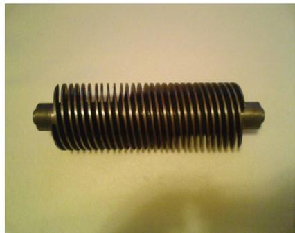
**Figura 16.** Trocador de calor de ferro fundido usinado (peça finalizada).
