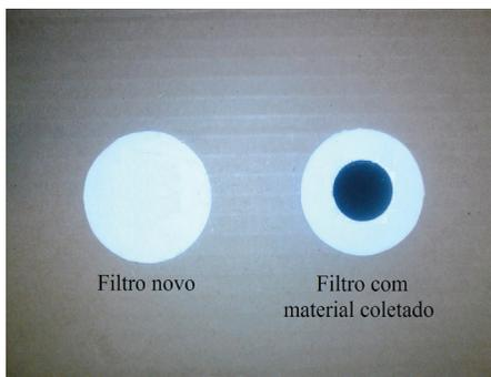
**Figura 6.** Filtros de fibra de vidro antes e após a coleta de particulados.
