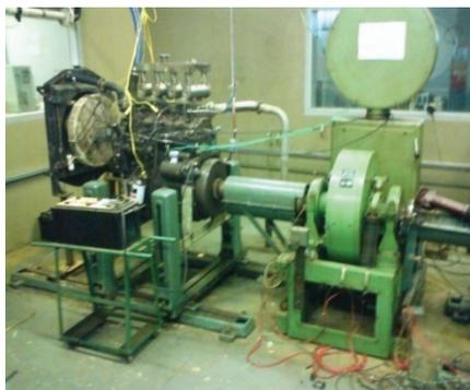
**Figura 2.** Motor em bancada dinâmométrica.
