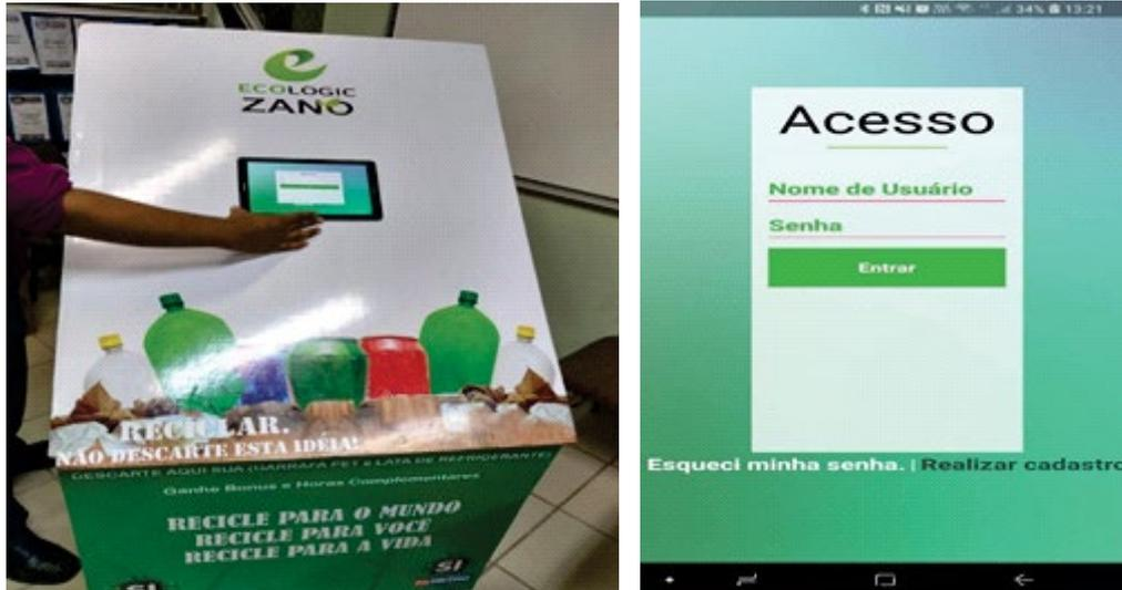
Figura 1. Caixa já envelopada com tablet (A) e tela de login do usuário (B).
