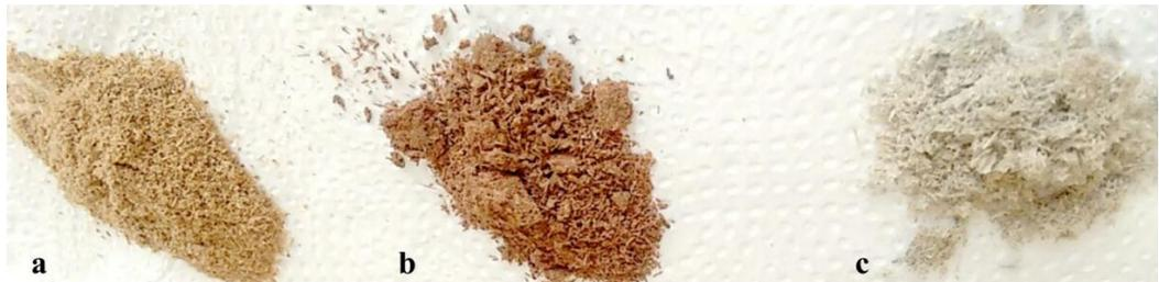
(a) biomassa *in natura*, (b) biomassa após tratamento com  $H_2SO_4$ , (c) biomassa após tratamento com  $H_2SO_4 + NaOH$ . Fonte: *Próprio autor, 2018.*
