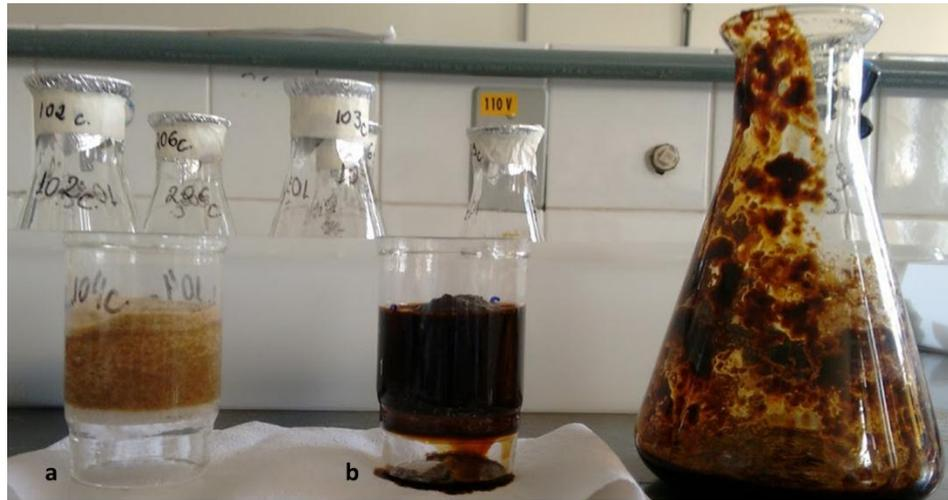
(a) cadinho com a biomassa de sorgo deslignificada, após neutralização e filtração a vácuo, (b) cadinho com a biomassa deslignificada antes da neutralização e filtração. Fonte: *Próprio autor, 2018.*
