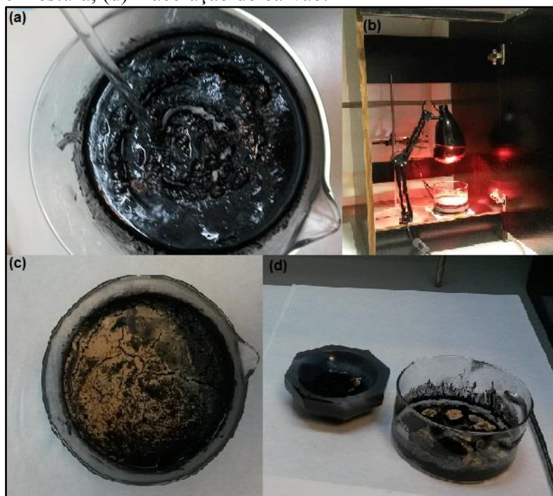
Figura 23. (a) mistura de carvão com KOH; (b) secagem em infravermelho; (c) carvão seco em estufa; (d) maceração do carvão.
