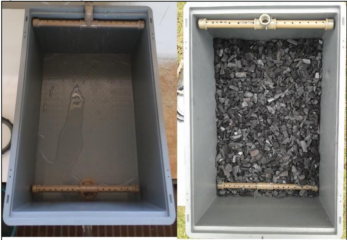
Figura 8. Tubulações perfuradas nas wetlands .
