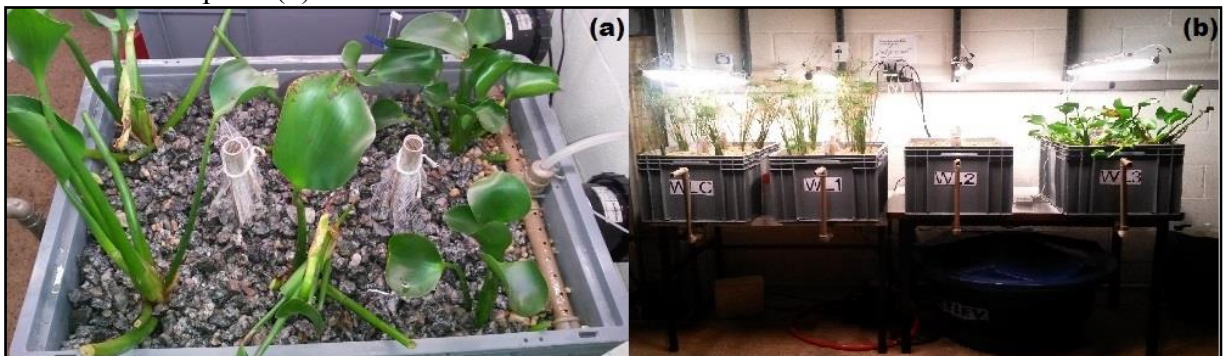
Figura 11. Detalhe das tubulações que foram colocadas a cada terço da caixa (a) e sistema de tratamento completo (b).
