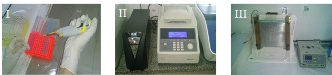
Figura 3. Representação dos procedimentos para a amplificação de DNA: I) Preparo das reações (PCR); II) Amplificação em termociclador; III) Eletroforese em cuba vertical.
