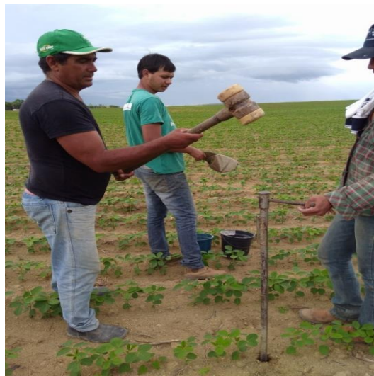
Figura 6 - Coleta de solo na área experimental para retirada de amostras deformadas de solo com uso de trado tipo sonda.
