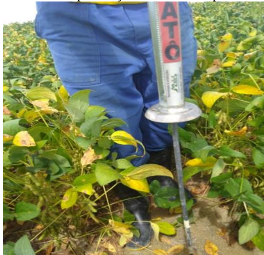
Figura 7 - Avaliação da resistência do solo à penetração com o uso de penetrômetro Hatô.
