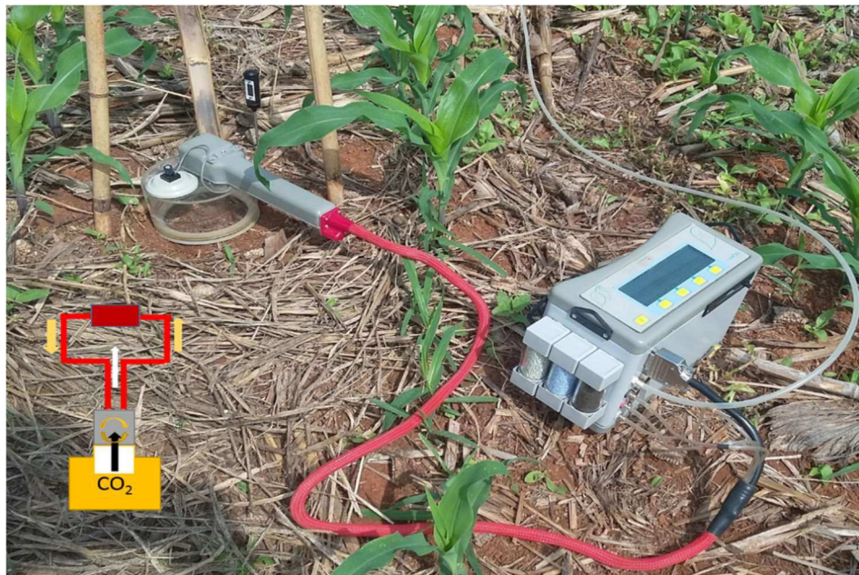
Fig. 3 – Sistema de medição do efluxo de CO 2 do solo sob sistema de plantio direto por sensor de infravermelho (IRGA), durante a safra agrícola 2015/2016, Sete Lagoas, MG, Brasil.
