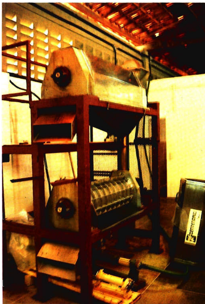
FIG. 18. Despoldadeira de graviola Centenário possui rendimento de 1,25 ton de polpa/hora.
