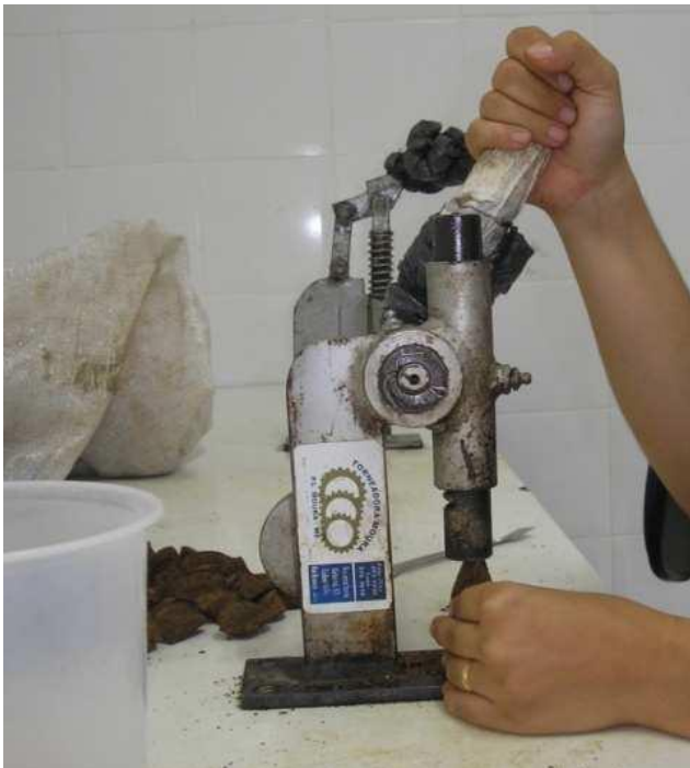
Figura 5 - Máquina adaptada para extração da amêndoa de castanha-do-brasil. Fonte: Nogueira (2011).
