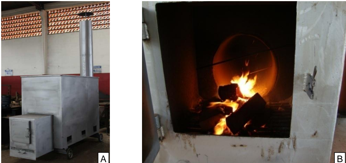
Figura 3 - Protótipo do secador utilizado nos experimentos com a castanha-do-brasil (A) com detalhe de sua fornalha (B) Fonte: Nogueira (2011).
