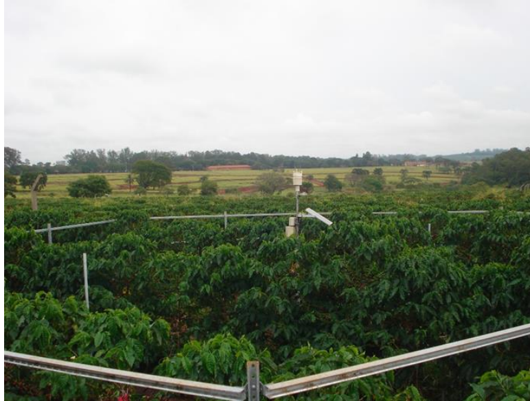
Figura 1 - Parcela do experimento FACE no campo experimental da Embrapa Meio Ambiente com injeção de CO 2 .
