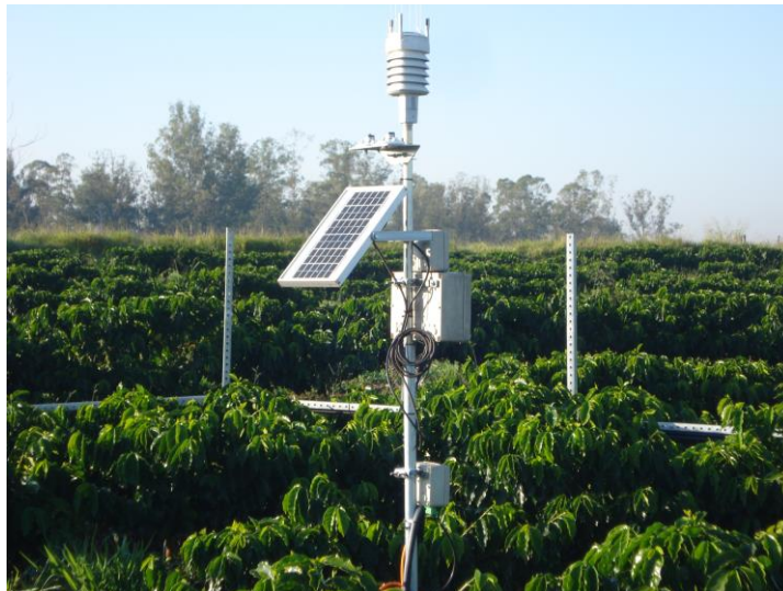
Figura 2 - Estação meteorológica localizada no centro de cada parcela com injeção de CO 2 .
