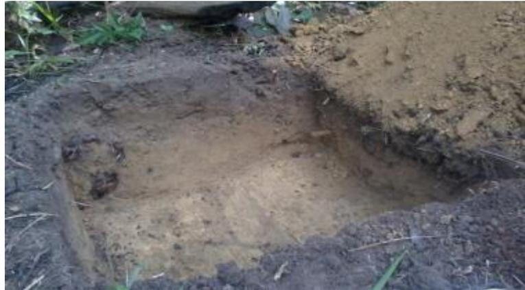
**Figura 3:** Trincheira utilizada para coleta de monólitos com dimensões de 70 cm de comprimento, 70 cm de largura e 40 cm de profundidade.
