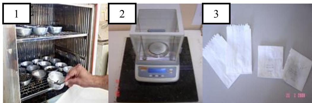
**Figura 8:** Equipamentos e material utilizado para quantificação da massa seca de raízes - 1: estufa, 2: balança de precisão, 3: sacos de papel para armazenagem das raízes secas
