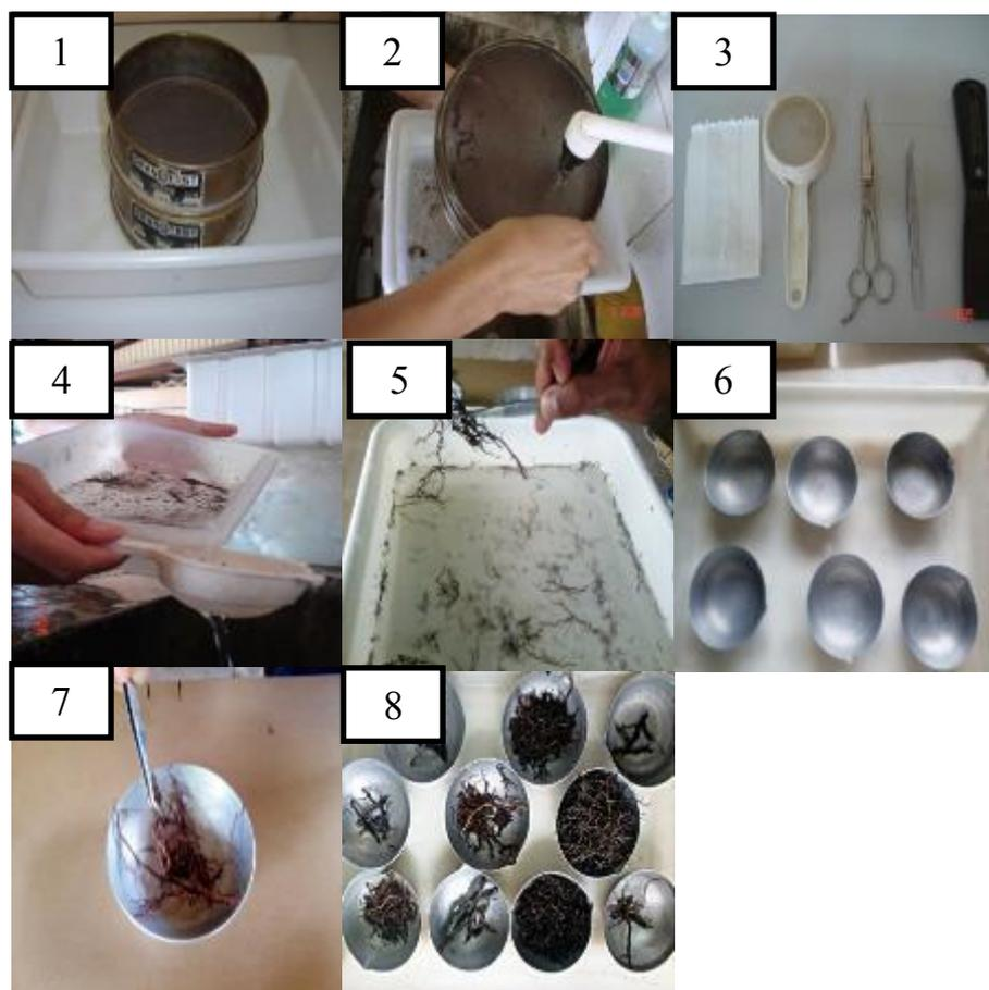
**Figura 11:** Metodologia de lavagem e separação de raízes 1: peneira duplas de 2 mm e 1 mm, 2: lavagem de solo nas peneiras, 3: material usado para separação e armazenamento de raízes (saco de papel, crivos, pinças e tesouras), 4: separação de raízes com peneira, 5: separação de raízes com pinças, 6: cadinhos metálicos, 7: cadinhos com raízes, 8: cadinho com raízes de vários diâmetros. **Fonte:** Ivana Reis
