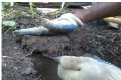
**Figura 5:** Bloco de solo retirado do monólito contendo raízes.
