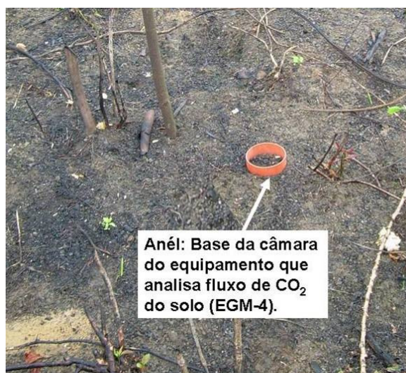
FIGURA 4 - Ilustração de um dos anéis de PVC instalado no solo das parcelas sob trituração, queima e capoeira. Estes anéis serviram de base para câmara do analisador EGM-4, que analisou o fluxo de \text{CO}_2 do solo.
