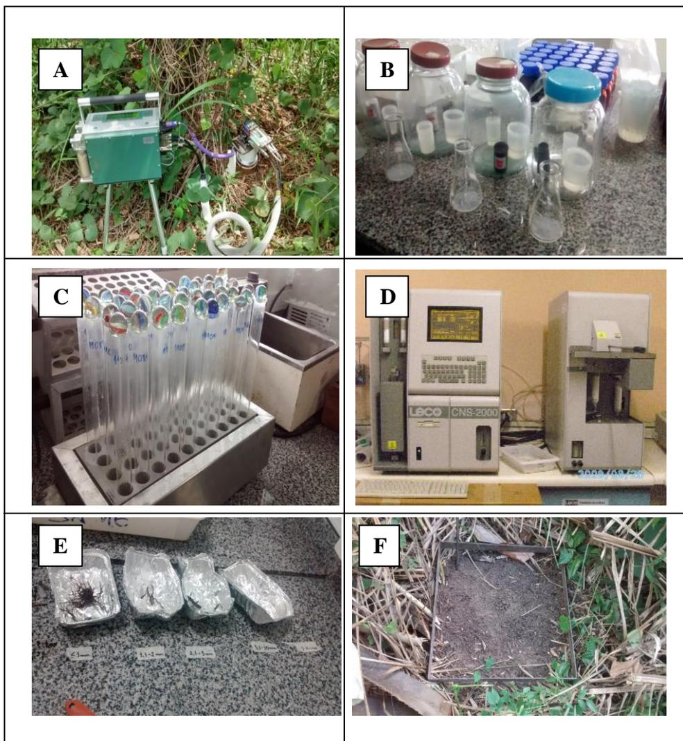
Figura 2. (A) Coleta do efluxo de  $\text{CO}_2$  do solo através do aparelho LI-COR 6400; (B) análise para obtenção da respiração basal do solo; (C) análise de carbono da biomassa microbiana do solo; (D) análise elementar de carbono orgânico total através do aparelho LECO; (E) classificação de raízes muito finas; e (F) coleta de serapilheira.
