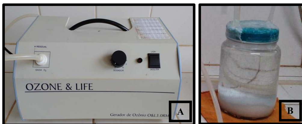
Figura 4 – Ozonizador (A). Recipiente com solução saturada de NaCl (B). Fonte: Arquivo pessoal do autor.
