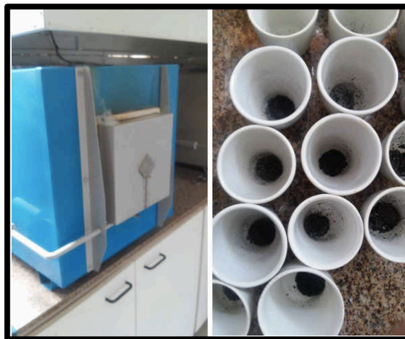
Figura 8 – Mufla e amostras em cadinho de porcelana depois de serem submetidas a queima a 600 °C por 4 h. Fonte: Arquivo pessoal do autor.
