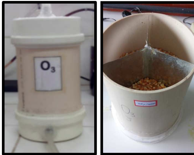
Figura 5 – Câmara de ozonização composta por cilindro de PVC utilizado para acondicionamento dos grãos submetidos ou não ao processo de ozonização. Fonte: Arquivo pessoal do autor.
