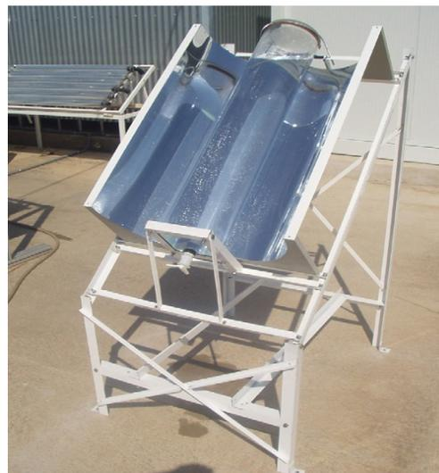
Figura 12. Reator em batelada com capacidade de 25 L para desinfecção da água.
