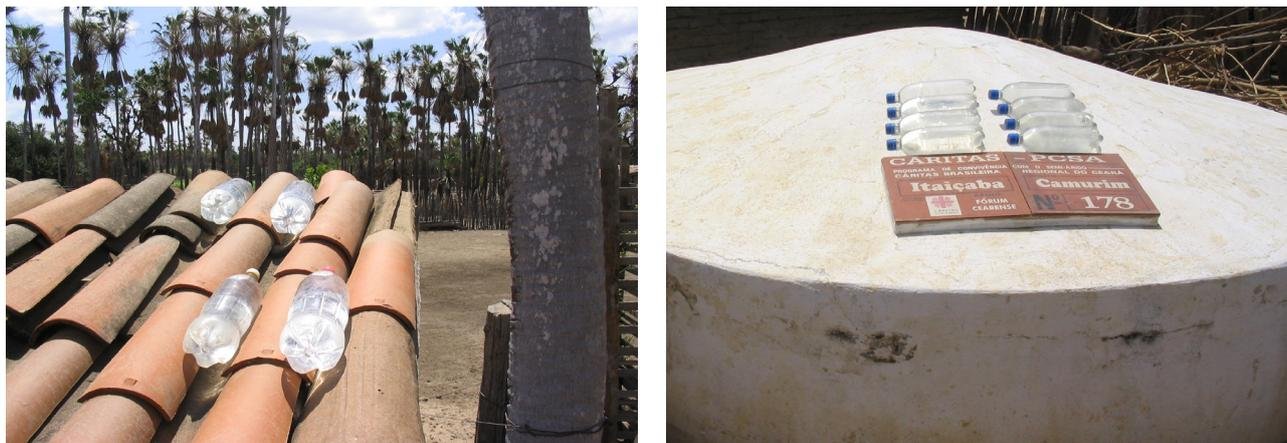
Figura 10. Locais de exposição das garrafas para o manejo do SODIS (A) Telha de barro (B) Cisterna de placa
