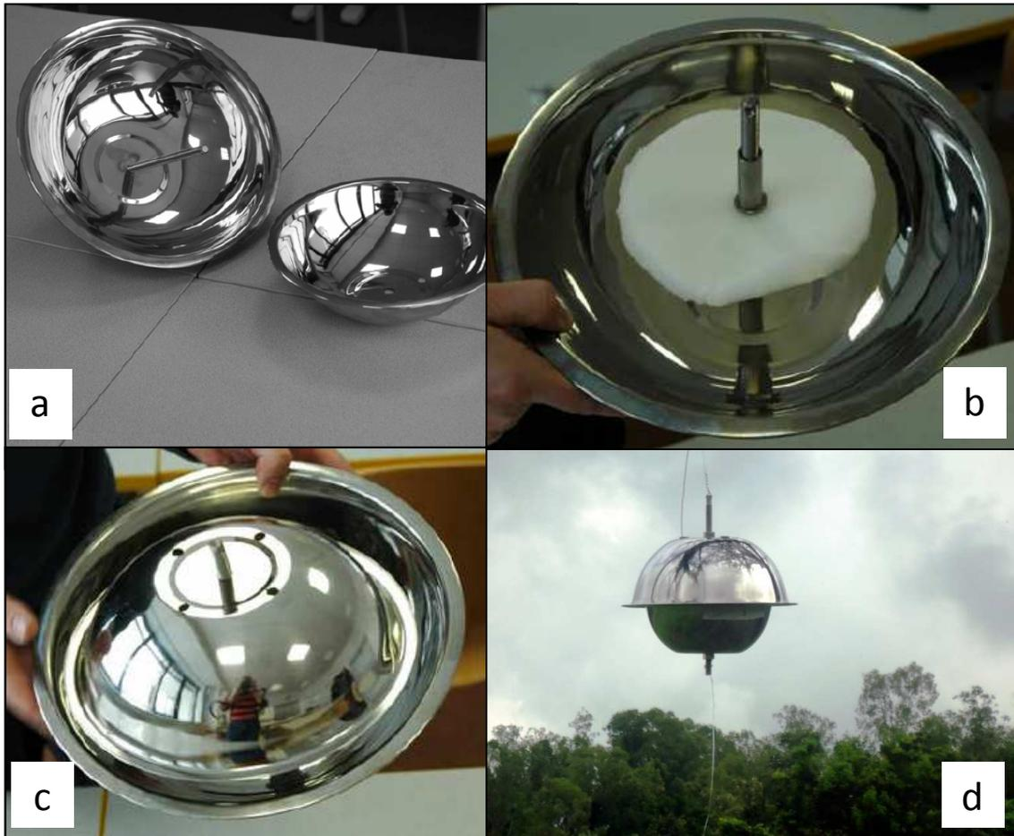
Figura 24. Dispositivo de amostragem passiva com disco de esponja de poliuretano PUF. a. bacias de inox com eixo central em inox; b. disco e esponja de poliuretano instalada no centro do dispositivo, fixada ao eixo central com o auxílio de porcas e arruelas em inox; c. instalação da bacia inferior, com os furos para drenagem da água; d. dispositivo instalado no campo.
