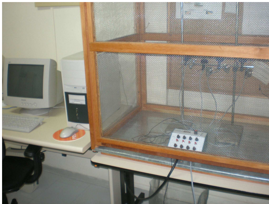
Figura 2 – “Gaiola de Faraday”, contendo no seu interior o equipamento GIGA 4 – DC, utilizada para redução das interferências durante os registros.
