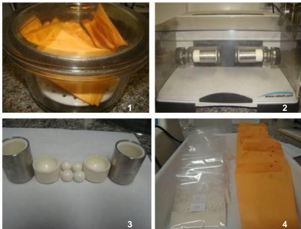
Figura 3 - Etapas do preparo das amostras para avaliação das características nutricionais de genótipos de feijão-caupi: 1 - Dessecador; 2 – Moinho de bolas de zircônio; 3 - Bolas de zircônio; 4 - Amostras moídas.
