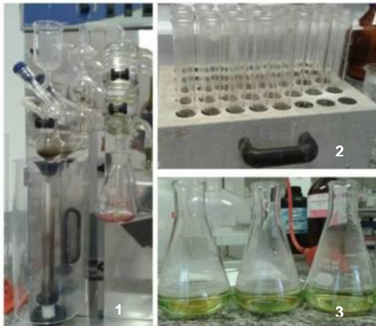
Figura 4 - Análise de proteína de genótipos de feijão-caupi: 1 – Destilação de nitrogênio da farinha obtida dos grãos; 2 – Amostra em bloco aquecedor após digestão; 3-Amostra após a destilação.
