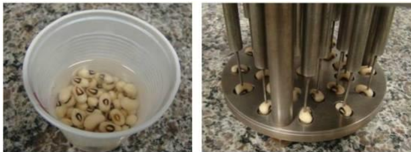
Figura 5 - Avaliação do tempo de cocção de genótipos de feijão-caupi em Cozedor de Mattson: grãos em embebição (à esquerda) e cozedor de Mattson com grãos de feijão (à direita).
