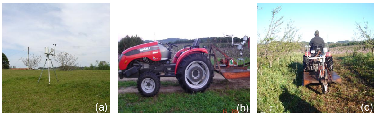
Figura 1- Estações automáticas para coleta de dados de temperatura e umidade relativa do ar no pomar de pessegueiro: (a) estação modelo Squitter próxima ao pomar; (b e c) estação móvel acoplada ao trator.
